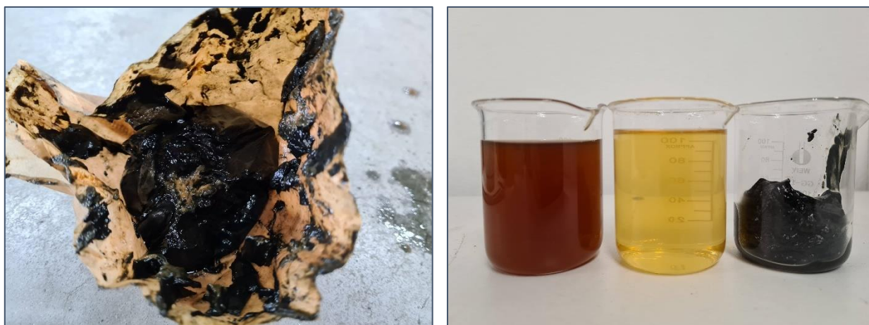
Figuur 14: Slib na elektrocoagulatie (links) en ingaande stroom en dunne en dikke fractie na elektrocoagulatie (rechts).
