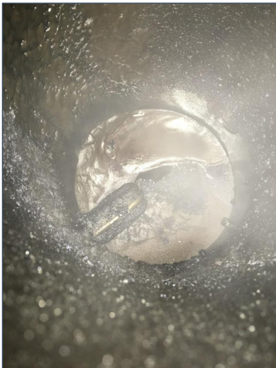
Figuur 10: Foto's van de kristallisatie aan de ketelwand.
