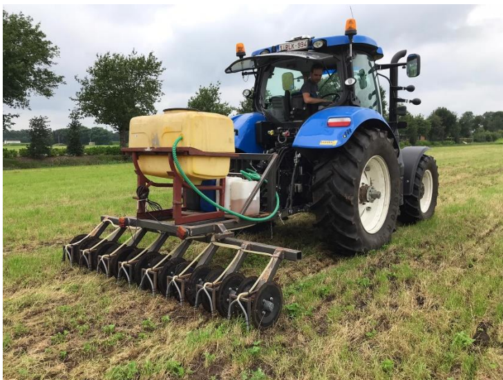
FOTO 2: TOEDIENING VAN HERWONNEN MESTSTOFFEN MET PROEFVELDBEMESTER 2021
