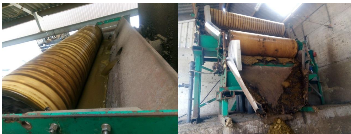
Figuur 13 links: bandenpers met ingaande runderdrijfmest, rechts: bandenpers met uitgaande dikke fractie.
