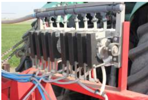
Figuur 3: Slangenpompjes gemonteerd op aardappelfrees
