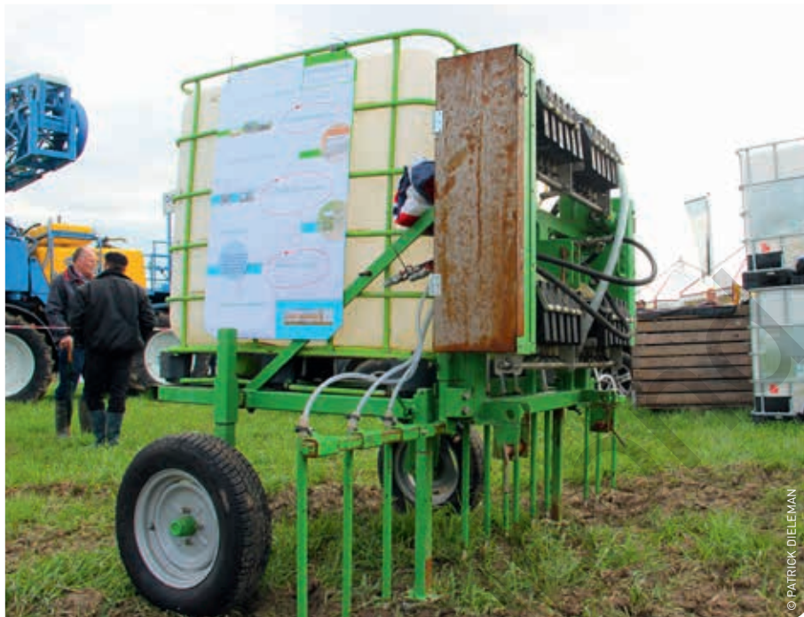
Met wat handigheid kan je met een tank en slangenpompjes zelf een rijenbemester maken om spuiwater mee toe te dienen
