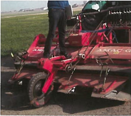
Fig 3. Rijenfrees met slangenpompsysteem
