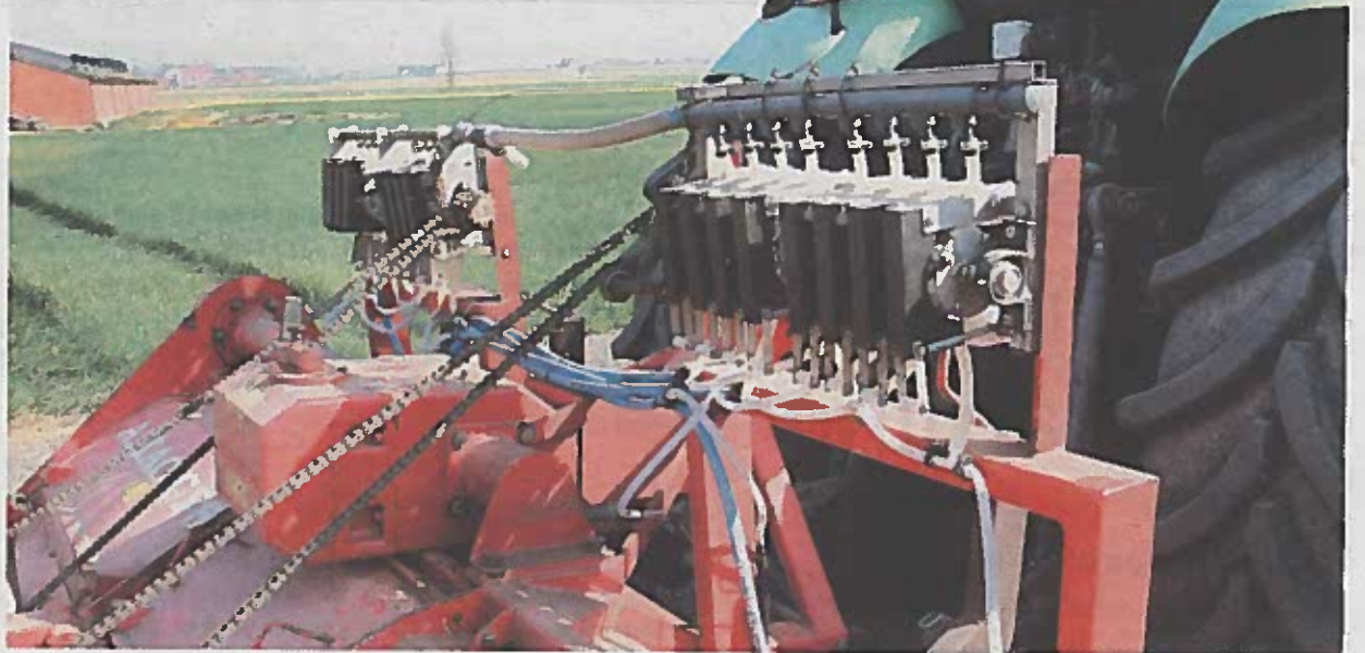
Via zestien slangenpompjes op de omgebouwde rijenfrees wordt het spuiwater toegediend aan beide zijden van de poter.
