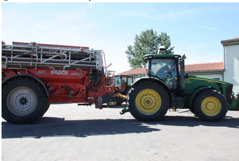
Figuur 9: Kunstmeststrooier. Merk de chlorofylsensor op de trekker.
