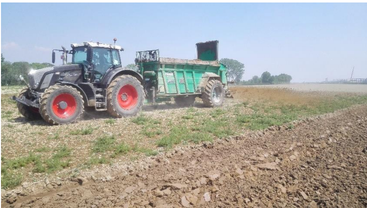
Figuur 7 Spreiden van dikke fractie runderdrijfmest met een stalmentstrooier
