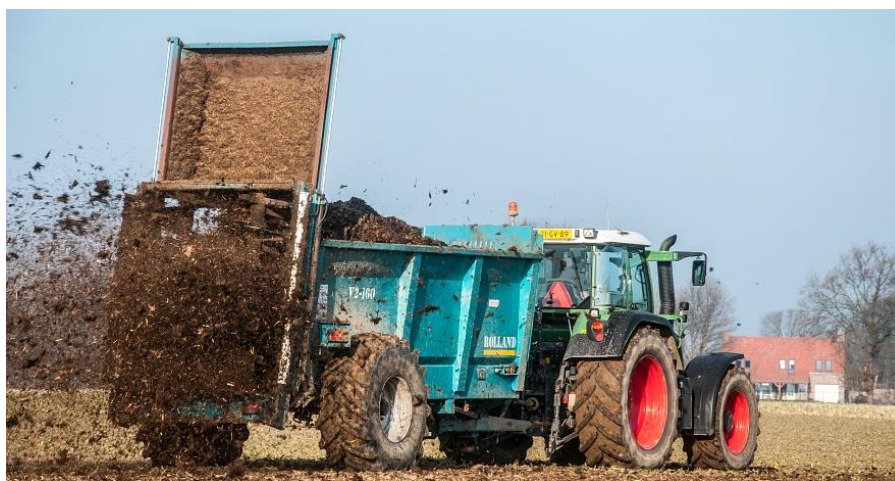
Figuur 10 Mestspreader met verticale molens bij het uitspreiden van stalmest (Vanduffel, 2015).
